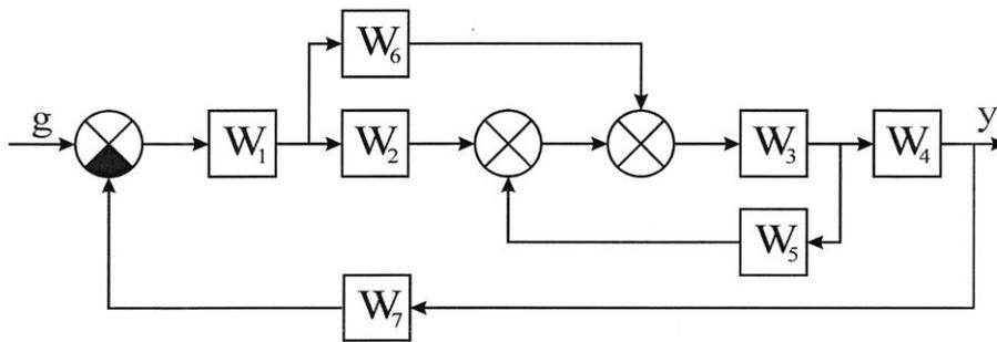
**Задание 5.** Выполнить эквивалентные преобразования структурной схемы и определить передаточную функцию замкнутой системы управления
