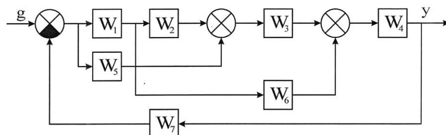
**Задание 4.** Выполнить эквивалентные преобразования структурной схемы и определить передаточную функцию замкнутой системы управления
