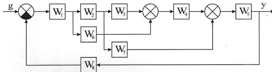
**Задание 6.** Выполнить эквивалентные преобразования структурной схемы и определить передаточную функцию замкнутой системы управления
