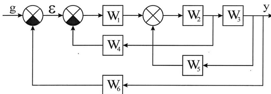
**Задание 2.** Выполнить эквивалентные преобразования структурной схемы и определить передаточную функцию замкнутой системы управления
