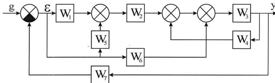
**Задание 7.** Представить передаточную функцию в виде соединения типовых динамических звеньев, построить ЛАЧХ и ЛФЧХ.
