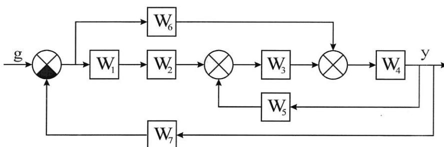
**Задание 3.** Выполнить эквивалентные преобразования структурной схемы и определить передаточную функцию замкнутой системы управления
