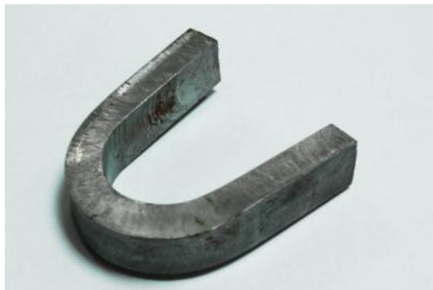
Рис. 3. Вид образца после испытания на изгиб
