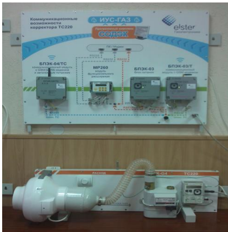
Рис. 1. Внешний вид стенда для изучения коммуникационных возможностей корректора ТС220
