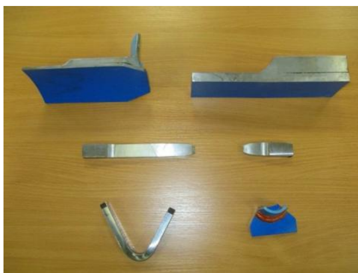
Рис. 2. Образцы механических испытаний КСС
